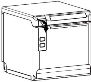
2. Instale el rollo de papel en la dirección correcta del rollo.
