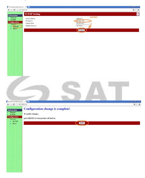
**NOTA:** con este proceso ya hemos garantizado el cambio de la dirección IP de la impresora SAT 38T a la red que se desea conectar.
