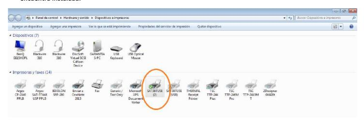
NOTA. Con este proceso ya tenemos la instalación de la impresora SAT 38T con una comunicación por red. Si ingresamos a las propiedades de impresora, podemos comprobar el puerto por el cual se está comunicando la impresora.
