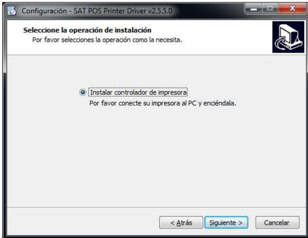
(6) Seleccione el tipo de Puerto (USBxxx es para Puerto USB, COMx es para puerto serial, LPTx es para puerto paralelo). Seleccione el tipo de driver, puerto, ejemplo "COM1" como puerto. Haga clic en "Configurar Puerto".
